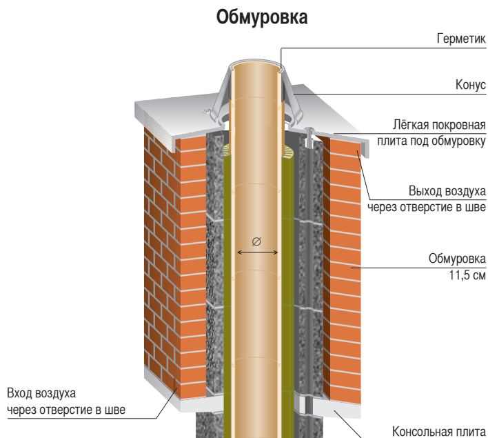
Выполняемая по месту обмуровка на консольной плите
